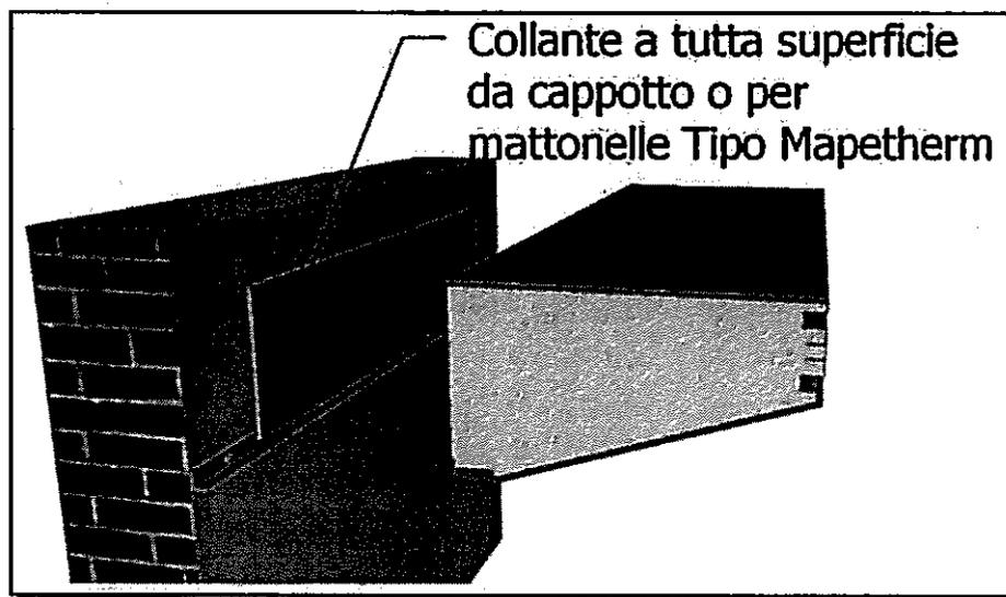
8) Riposizionare il cornicione sull'angolare e fissarlo con le barre filettate (ancorante ad espansione) previo inserimento della barra a "c".
