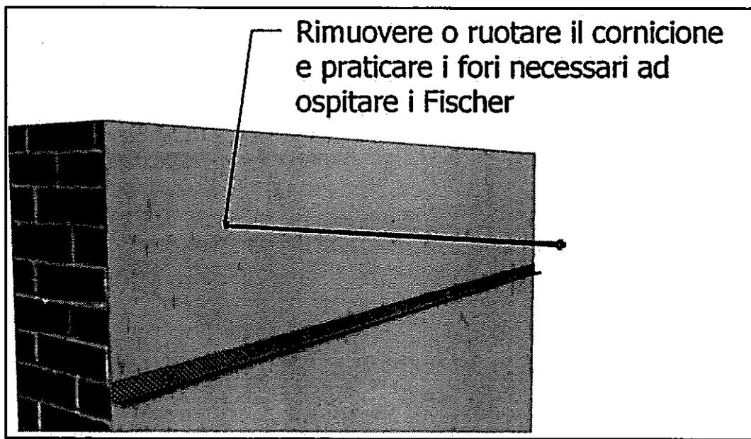
7) Posare su tutta superficie, il collante nella misura di circa 5 mm sia sul profilo (cornicione) che sulla parete (parte trave in c.a. e parte muratura di tomagno con forati di laterizio).
