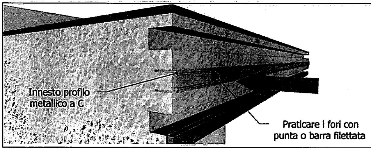
6) Rimuovere e/o ruotare il cornicione precedentemente appoggiato e praticare i fori sulla parete (trave in c.a.) necessari ad ospitare i Fischer (ancoranti ad espansione) e pulizia del foro con aria compressa.
