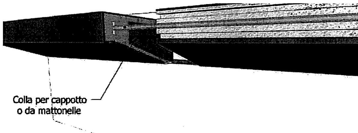
12) Impermeabilizzazione dell'estradosso e del frontale del cornicione e del verticale del bauletto per un'altezza di circa cm. 20 con malta impermeabilizzante tipo Mapelastic della Mapei o prodotto equivalente.
