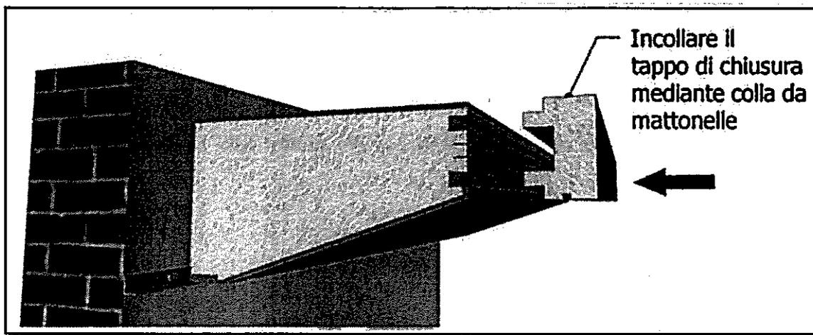
10) Sigillare il perimetro delle giunture mediante pasta per giunti dinamici.
